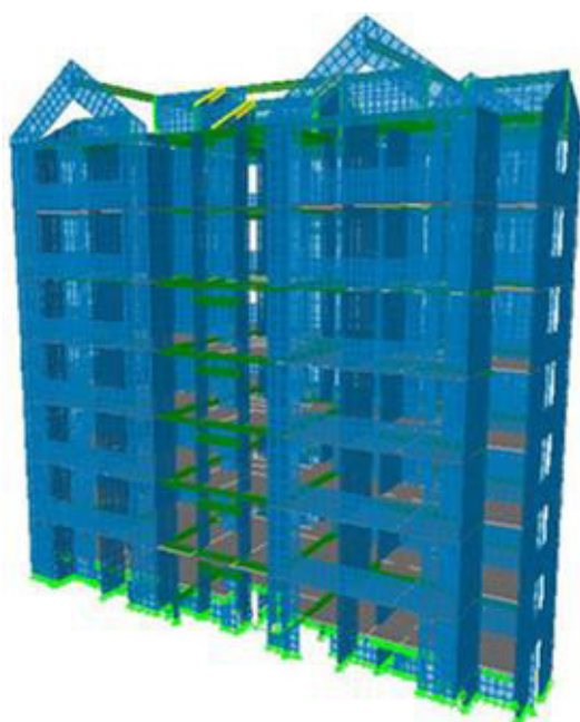
Figura 9. Modelo tridimensional realizado con elementos finitos de la estructura.
